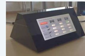
Touch-Panel zur Mediensteuerung
